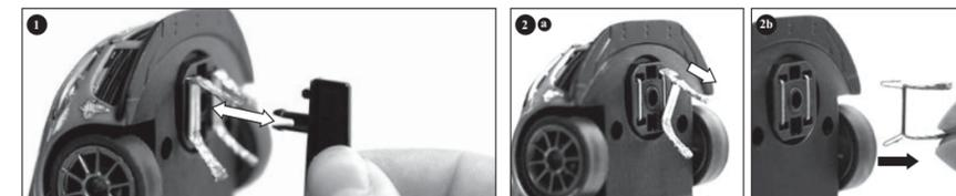
Opatrně vytáhněte vodící kíl podle obr. 1. Obr. 2 Při výměně dvojitých kontaktních kartáčků dbejte na to, aby byl nejdříve částečně vytažen pouze horní kontaktní kartáček (a) a poté v druhé fázi je možné kontaktní kartáčky vytáhnout úplně (b). Pro vložení postupujte stejným způsobem.
