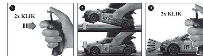
Položte auto na dráhu, zmáčkněte 2x tlačítko pro změnu jízdního pruhu obr. 1, zvedněte přední část auta a znovu ho položte obr. 2, pokud světla auta blikají stiskněte dvakrát tlačítko pro změnu jízdního pruhu obr. 3. Programování je potvrzeno tónem. Všechna nastavení jsou uložena do doby, než provedete nové nastavení
