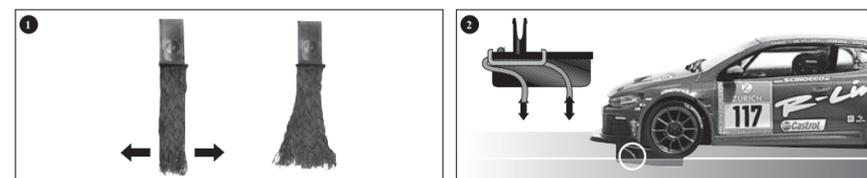
Auto Carrera DIGITAL 132 ideálně odpovídá dráze Carrera měřítko 1:24. Pro zajištění správné a plynulé jízdy roztáhněte kontaktní kartáčky trochu do tvaru vějíře 1 a ohněte je směrem k dráze podle obr. 2. Jen konce kontaktních kartáčků mohou být v kontaktu s tratí a mohou být jemně odstříženy v případě opotřebování. Prach a oděry by měly být z tratě a kontaktních kartáčků čas od času odstraněny.
