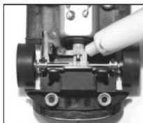
Kontrola auta: Čistěte nápravu a ložiska kol, pastorek převodovky, ozubená kolečka a ložiska promazávejte pryskyřicí a nemastnými přípravky. Můžete použít například párátka. Pravidelně kontrolujte stav posuvných kontaktů a pneumatik.
