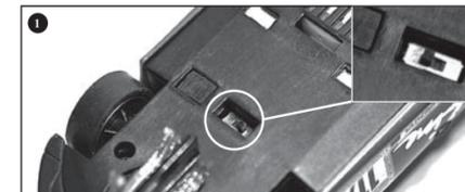
Položte auto na dráhu Evolution a zmáčkněte třikrát horní tlačítko (palcem) na ovladači rychlosti. Stiskněte přepínač pro změnu směru jízdy podle obr. 1 Pro operační mód Carreru DIGITAL 132 vraťte přepínač do původní pozice.
