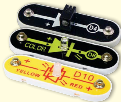
Biela, farebná a červená/žltá LED dióda (D4, D8 a D10)
